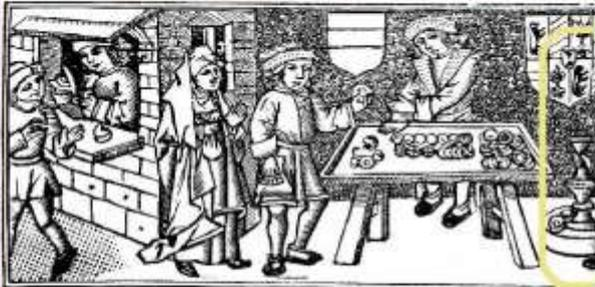
При ручной чеканке деньги изготавливали исключительно ручным способом при помощи двух штампов и молотка.
