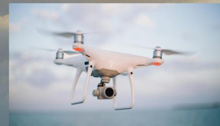
**Под беспилотным летательным аппаратом (БПЛА) понимается воздушное судно, предназначенное для выполнения полета без экипажа на борту, которое осуществляет полет вне условий визуального контакта с ним посредством ноутбука, планшета, мобильного телефона, иного устройства. К ним относятся дроны и квадрокоптеры.**
