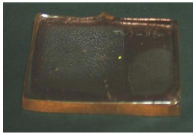
Рисунок 3 – Фотография стекла (мол. %) 60TeO<sub>2</sub>–24,5WO<sub>3</sub>–14Yb<sub>2</sub>O<sub>3</sub>–1,5Er<sub>2</sub>O<sub>3</sub> и визуализируемого излучения с  $\lambda=970$  нм.
