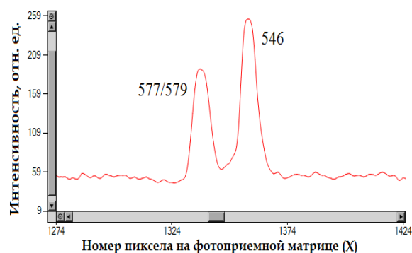
Рисунок 3 – Фрагмент спектра в G-канале, содержащий дублет 577/579 нм и линию 546 нм
