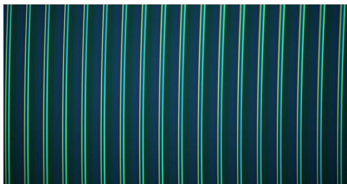
Рисунок 2 – Спектрально диспергированные изображения щелей при освещении светом ртутной лампы
