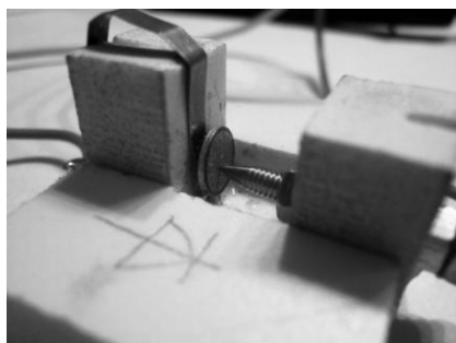
Рисунок 3 – Установка для изучения p-n перехода
