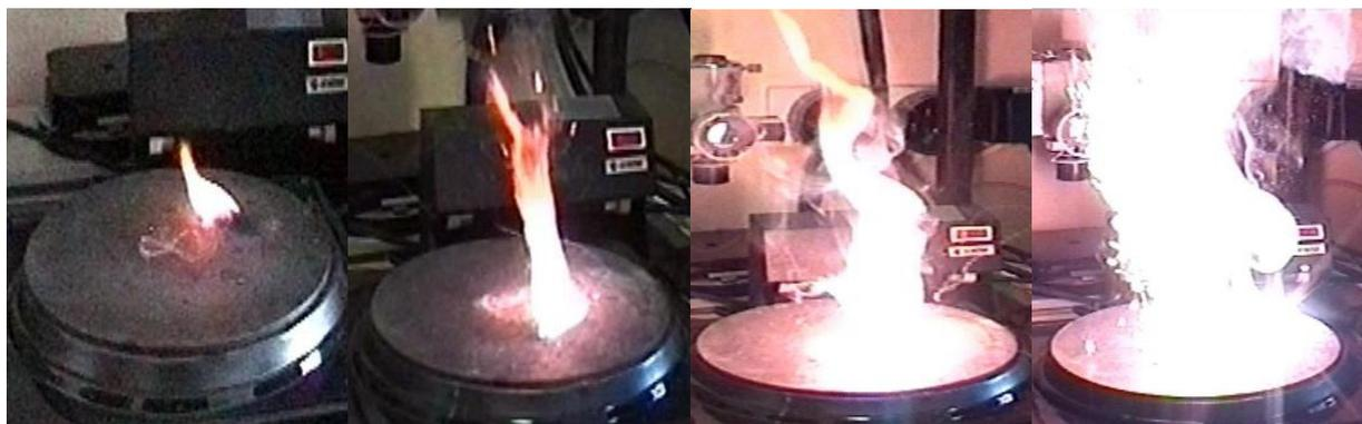
**Рисунок 2 – Динамика горения наноразмерных порошков кремния в присутствии перхлората натрия (калия) в режиме дефлаграции**
