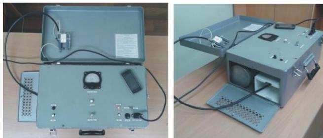
**Рисунок 2 – Внешний вид малогабаритного электроразрядного устройства**
