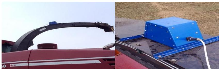
**Рисунок 2 – Фотографии макета датчика влажности зелёной массы во время проведения полевых испытаний**
