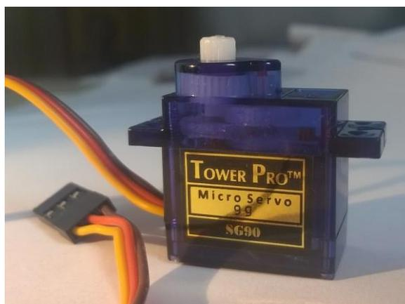
Рисунок 1 – Сервопривод Tower Pro SG90
