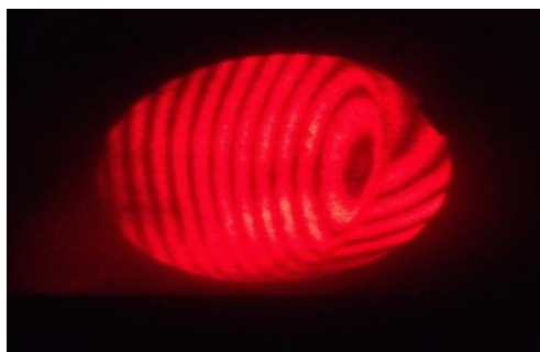
Рисунок 1 – Изменение хода интерференционных полос на границе изменения показателя преломления
