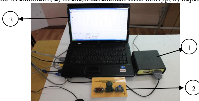
Рисунок 2 - Унифицированная установка для активной демонстрации электромагнитных колебаний
