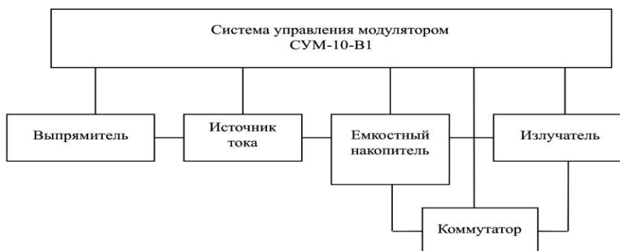
Рисунок 1 – Структурная схема частотного электрогидравлического устройства
