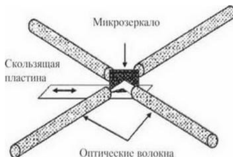
Рисунок 4 – Схематическое изображение обводного волоконно-оптического переключателя
