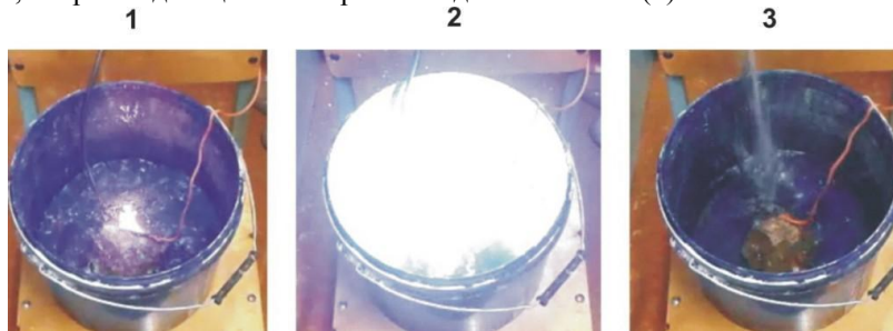
Рисунок 2 – Последовательные фазы частотного электрогидравлического воздействия на фрагмент железобетонной плиты, находящейся в емкости с водой: 1 – начало процесса, 2 – максимальная фаза, 3 – финальная фаза
