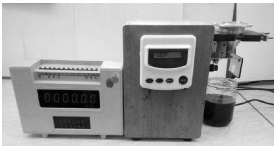
Рисунок 3 – Внешний вид автоматизированной системы Viscosus
