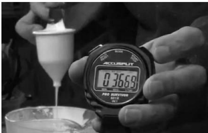
Рисунок 1 – Процесс определения условной вязкости краски
