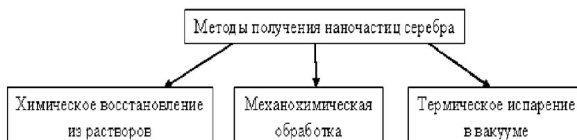
Рисунок 1 – Способы получения наночастиц серебра
