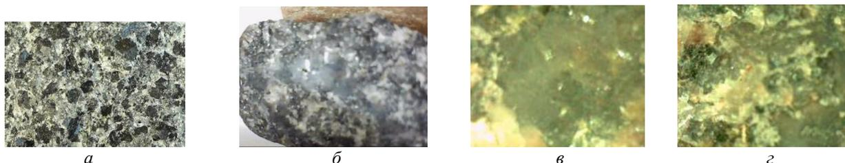
Рисунок 1 – Снимки поверхности диорита: а) и б) общий вид образца (взб-камера), в) увеличенный чёрный участок образца, г) увеличенный светлый участок образца (цифровой микроскоп WEBBERS F2n, увеличение  $\times 50$ )
