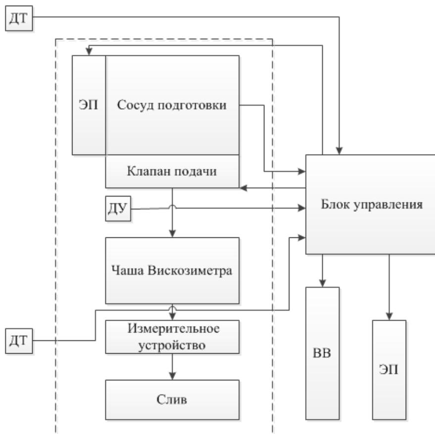
ДТ – датчики температуры воздуха, ЭП – элемент Пельтье, ДУ – датчик уровня жидкости в чаше вискозиметра, ВВ – воздушный вентилятор
