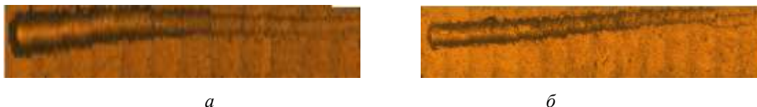
Рисунок 1 – Строение поверхности после проведения скретч-анализа: а) исходное покрытие; б) покрытие после 30 минут криогенной обработки
