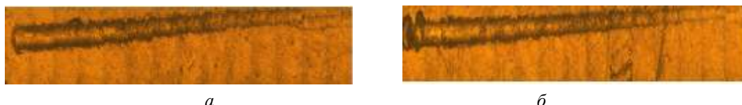
Рисунок 2 – Строение поверхности после проведения скретч-анализа: а) покрытие после 30 минут криогенной обработки; б) покрытие после 60 минут криогенной обработки
