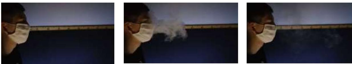
Рисунок 3 – Скриншоты выполненных экспериментов по определению геометрических параметров порции выдыхаемого воздуха
