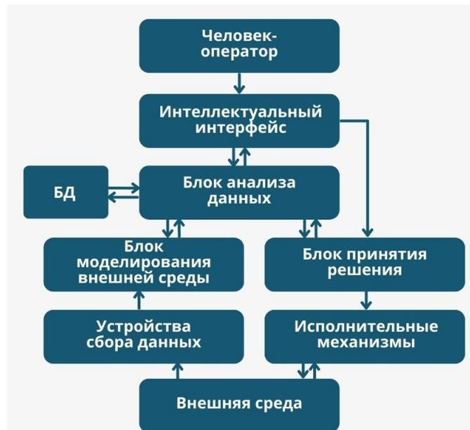
Рисунок 1 – Пример блок-схемы гипотетической структуры интеллектуального робота
