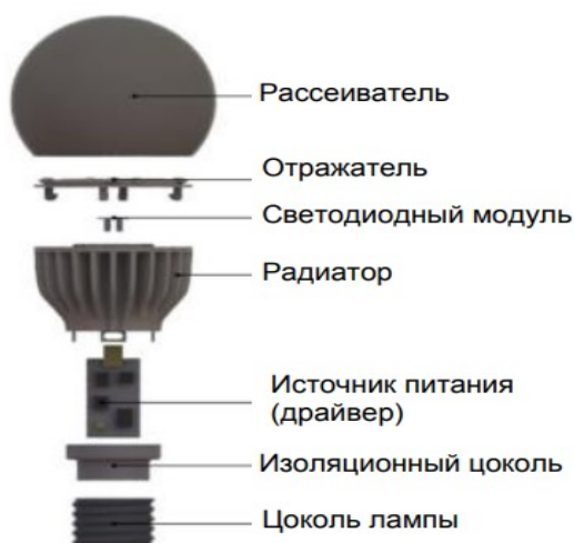
Рисунок 2 – Основные компоненты светодиодной лампы
