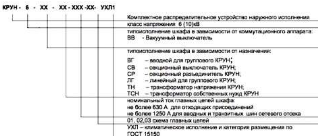
Рисунок 2 – Маркировка комплектных распределительных устройств наружного типа
