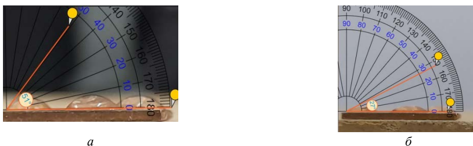
Рисунок 5 – Краевые углы смачивания образца М3 дистиллированной водой через 10 (а) и 600 (б) секунд
