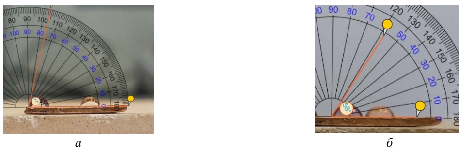
Рисунок 3 – Краевые углы смачивания образца М1 дистиллированной водой через 10 (а) и 600 (б) секунд
