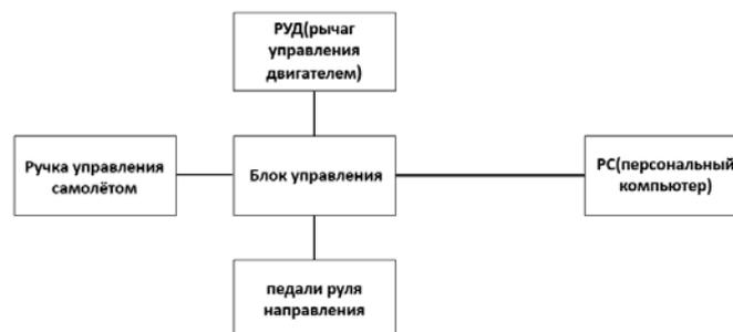
Рисунок 1 – Схема макета
