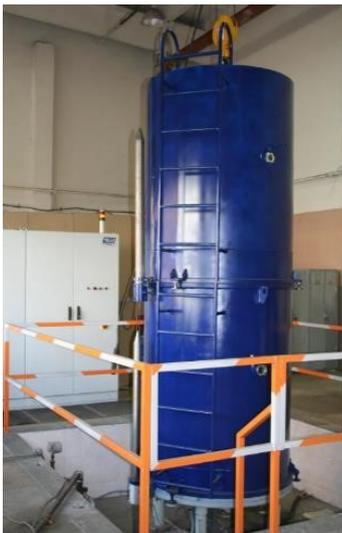
Рисунок 1 – Вид установки ИПА с двухсекционной камерой
