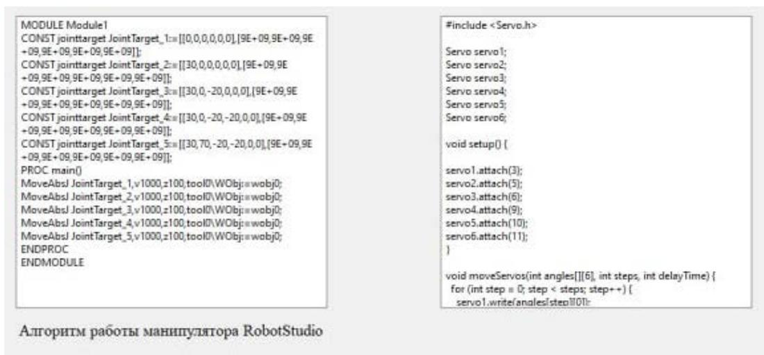
**Рисунок 3 – Обратное преобразование алгоритма программы ABB RobotStudio в алгоритм для лабораторной установки**
