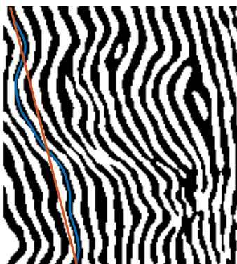
Рисунок 1 – Интерферограмма с выбранной для определения смещения от невозмущенного состояния темной полосы
