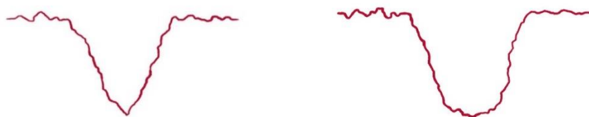
Рисунок 2 – Профили кратеров, полученные у образцов в ходе лазерной абляции
