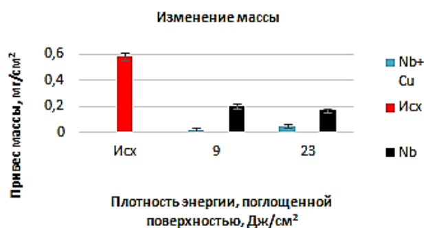
Рисунок 5 – Зависимость изменения массы от плотности энергии, поглощённой поверхностью, в сравнении с исходным образцом, после 3 ч отжига
