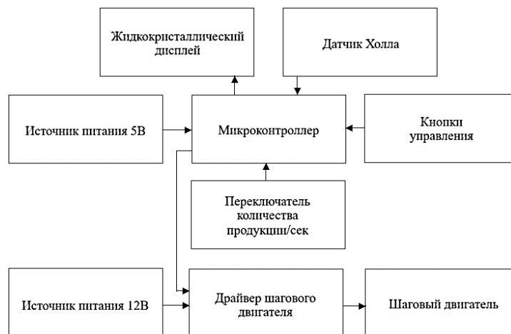
Рисунок 2 – Блок-схема устройства имитатора движения продукции на конвейерной ленте
