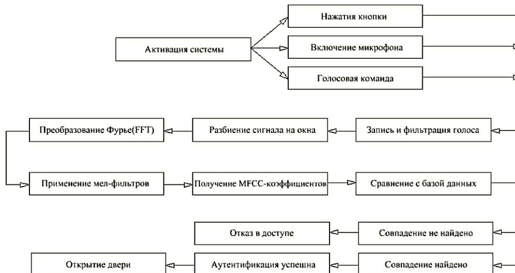
Рисунок 1 – Блок-схема «Система управления доступом»
