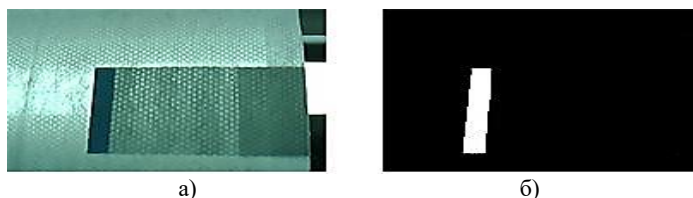
а) исходное изображение; б) результат работы оператора пороговой обработки.
