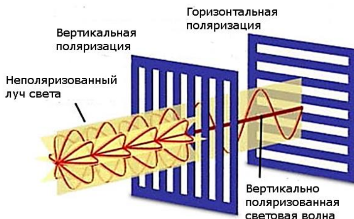
Рисунок 1 – Принцип работы поляризационной плёнки
